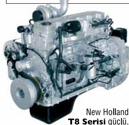
New Holland **T8 Serisi** güclü, **Tier 4A** emisyon seviyesinde **Cursor motorları** ile donatılmıştır. Performansın yanında çevre dostu motorlar üreten New Holland; **T8 Serisinde** kullandığı yeni **SCR Katalizör sistemi** ile eksoz gazında oluşan zararlı azot oksit gazını **AdBlue çözeltisi** kullanarak zararsız azot ve suya çevirmektedir. Motordan bağımsız olarak çalışan bu sistem ile motor içine temiz hava alınarak, açığa çıkan egzoz gazi da temizlenerken doğaya verilmektedir...
