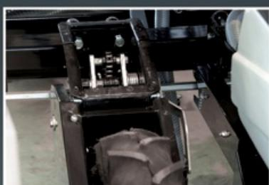
Parallelogram tipi bağlantı sistemi güçlündür. Merkezinde bulunan baskı yayının farklı pozisyonları ile toprağa uygulanan basınç kolaylıkla ayarlanır.
