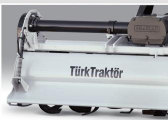
Rotorun arkasında bulunan sac karkasının pozisyonu ve baskı oranı kollar yardımıyla kolayca ayarlanabilmektedir. Rotor üzerindeki bıçakların ve sac karkasının oluşturduğu etki ile toprak istenilen oranda parçalanır.
