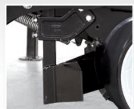
Balta tip çizi açıcılar istenilen derinlikte çizi açarak tohumun ekilmesi için uygun ortamı sağlar.
