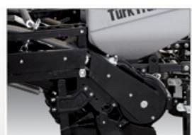
İstenilen ekim derinliği, baskı tekerleğinin yüksekliğinin değiştirilmesi ile ayarlanır. Baskı tekerleğinin özel yapısı, toprağa bırakılmış olan tohumun üzerinden ideal oranda bastırır.
